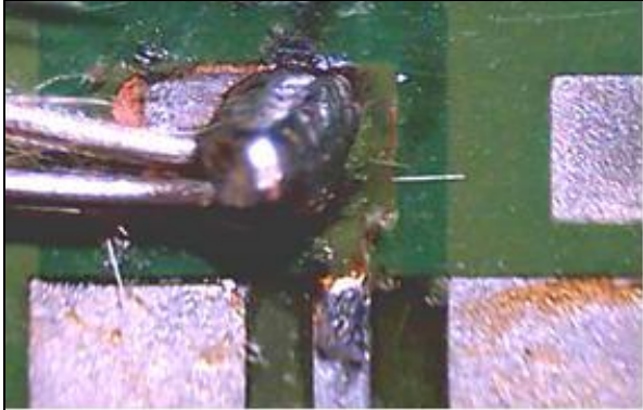
Bild 4: Befestigung mittels Hochtemperatur-Lot
